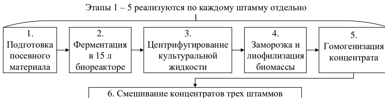
Рисунок 18 – Схема получения прототипа биопрепарата для растениеводства
