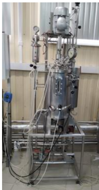
Рисунок 16 – Использованный ферментер объемом 15 л (ООО «Сторге», г. Санкт-Петербург)
